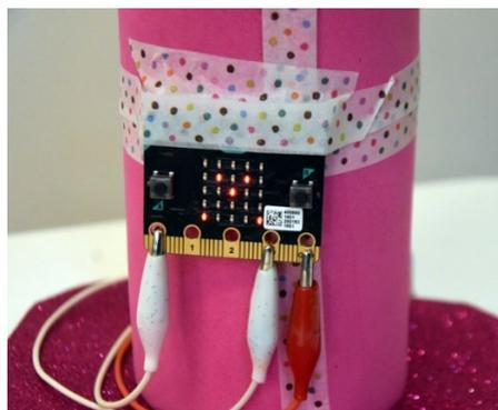
*Figura 7. Pormenor da micro:bit que controla o sistema de iluminação*
